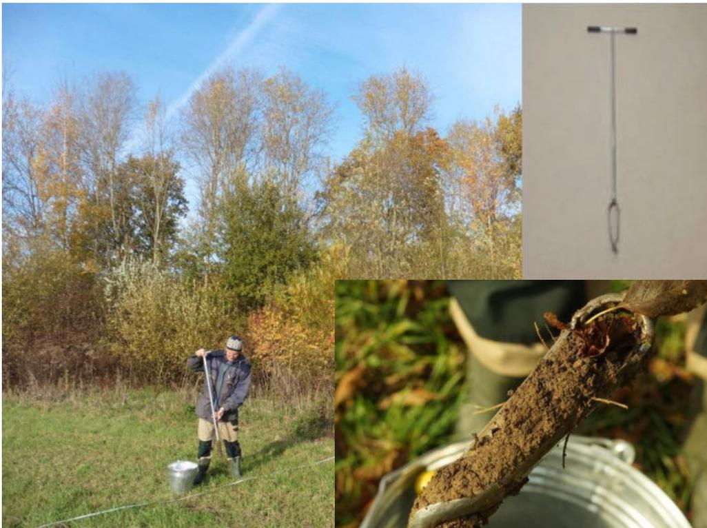
Abbildung 2. Probenahmeschnecke zur Entnahme von Bodenproben
